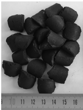
Rys. 1. Paliwo kompozytowe na bazie węgla kamiennego objętości o 1,5 \text{ cm}^3 wytworzone w prasie walcowej.
